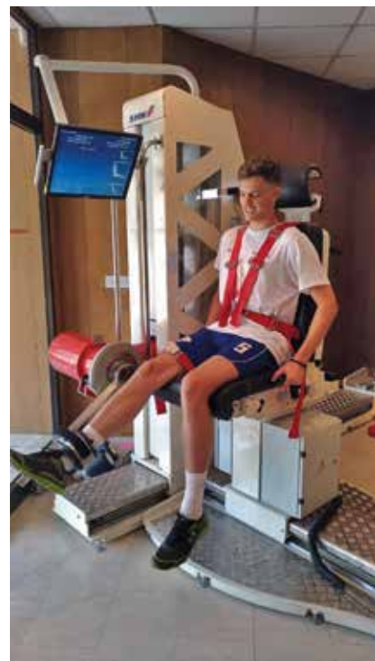
Slika 3. Meritev jakosti iztegovalk in upogibalk kolena na izokinetičnem dinamometru (osebni arhiv).
